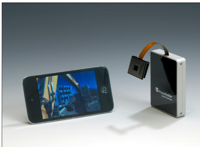
Der erste Prototyp der Technologie überträgt die Bilder der Kamera noch via Bluetooth über eine Sendebox an das Smartphone. © Fraunhofer IOF | Bild in Farbe und Druckqualität: [www.fraunhofer.de/presse](http://www.fraunhofer.de/presse).
